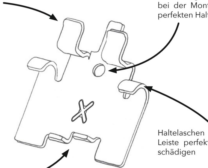
Haltetaschen stabilisieren die Leiste perfekt, ohne sie zu beschädigen
