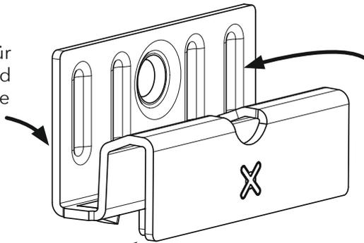
Stabilisierungszonen wirken den Verformungskräften zur Unterkonstruktion entgegen
