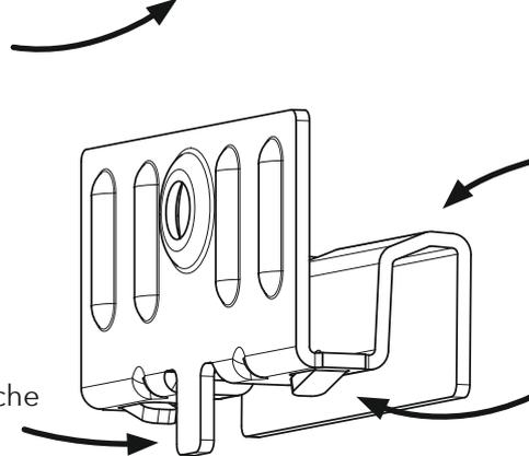
Schräg geführter Aufnahmeanschlag für ein einfaches Aufsetzen der Fassadenprofile
